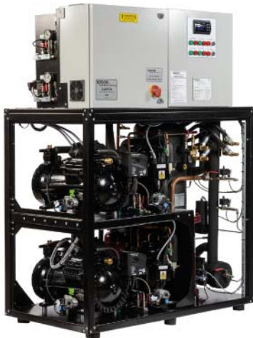
Figuur 1, Voorbeeld van een R744-systeem
