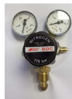
Figuur 9, geschikte regelaar voor druktests op R744-systemen
