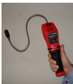
Figuur 6, Elektronische lekdetectors geschikt voor koolwaterstoffen
