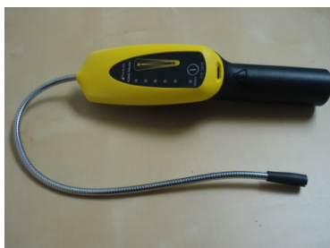
Figuur 6, Elektronische lekdetectors geschikt voor koolwaterstoffen
