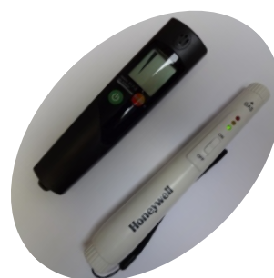
Figuur 2, Detectoren voor brandbare gassen
